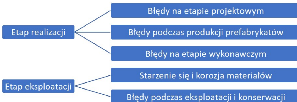
Rys. 32. Przyczyny i rodzaje uszkodzeń w budynkach wznoszonych metodami uprzemysłowionymi [15].
