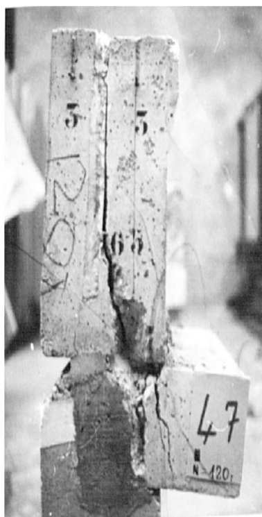
Rys. 66. Przykładowe zarysowania zestawu badawczego poddanego działaniu obciążenia [6].
