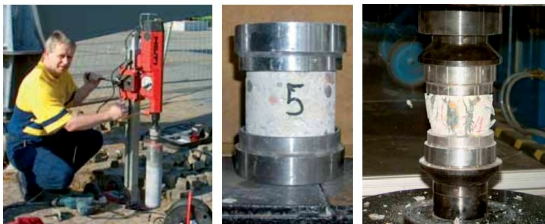
Rys. 30. Przygotowanie próbki oraz przeprowadzenie badania wytrzymałości na ściskanie [66].
