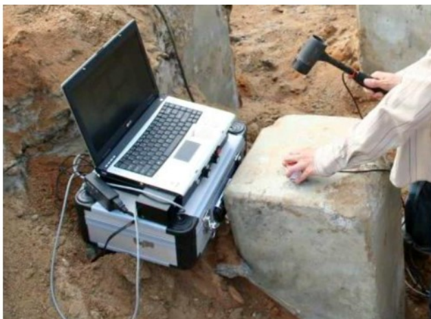
Rys. 19. Badanie ciągłości pali fundamentowych [48].
